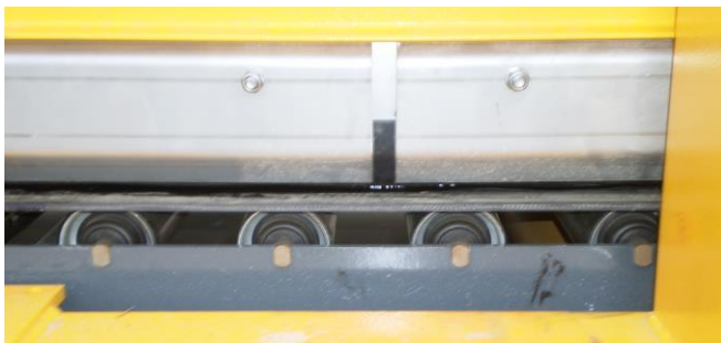
Abbildung 2: Fördergurt auf Schwerlasttragrollen
